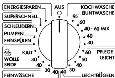
Установите селектор программ на выбранную программу; загораются индикаторы этапов, составляющих выбранную программу. В положении селектора ВЫКЛ (AUS) прибор выключен. Переведя селектор в это положение вы можете отменить выбранную программу стирки. Затем можно выбрать новую программу.
