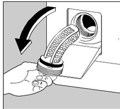
Полностью отвинтите крышку и выньте фильтр наружу. Промойте фильтр под струей воды. Затем вставьте фильтр назад и завинтите крышку по часовой стрелке.
