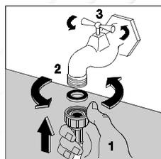
Прикрутите заливной шланг к крану подачи воды (20x27 мм), не забудьте установить прокладку, поставляемую со стиральной машиной. Откройте кран подачи воды.
