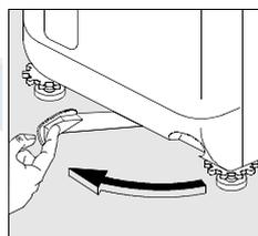
Если вы хотите переставить стиральную машину, поднимите ее на колесики – для этого поверните рычаг внизу машины влево. После того, как машина будет установлена на нужное место, установите рычаг в исходное положение.
