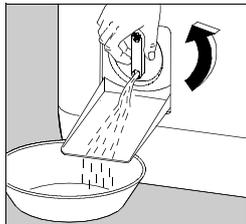
Подставьте под слив лоток. Поверните крышку против часовой стрелки, пока она не окажется в вертикальном положении, чтобы слить оставшуюся воду.
