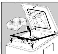
Откройте крышку стиральной машины и выньте приспособления, предотвращающие вращение барабана, и пластиковую прокладку. Закройте крышку.
