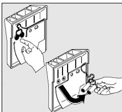
Теперь вы можете промыть дозатор под струей воды щеткой или скрученным куском ткани. Проверьте, не засорились ли сифоны на задней части дозатора.
